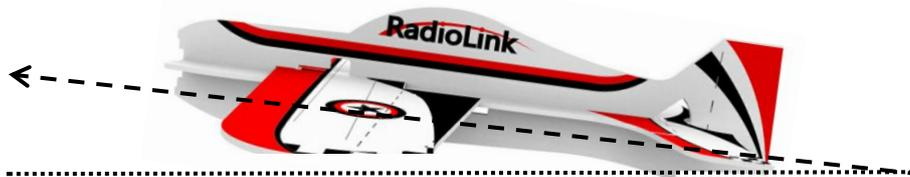
姿态校准动作：遥控器摇杆外八字，保持三秒以上，飞控绿色指示灯闪烁一下表示完成。此时舵面摆动一下或电机旋转一下皆为正常现象。
