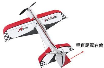
手动模式下，操作遥控器的摇杆，如果飞机对应通道的舵面运动方向反了，可以进入遥控器菜单，调整遥控器的舵机相位。
