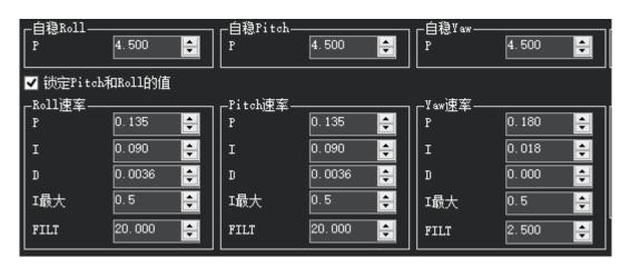
按照这套参数,我解锁轻推油,先是4个电机以同样的速度转动,油门超过阈值之后,控制信号开始参与。机子出现剧烈抖动,还蹿高。
